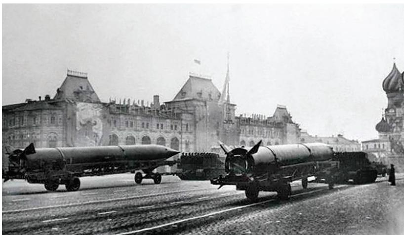
С 1951 года начались работы по ракете Р-5. По конструкции Р-5 являлась одноступенчатой ракетой с несущими баками с системой уменьшения невыработанных остатков топлива и отделяемой головной частью.
