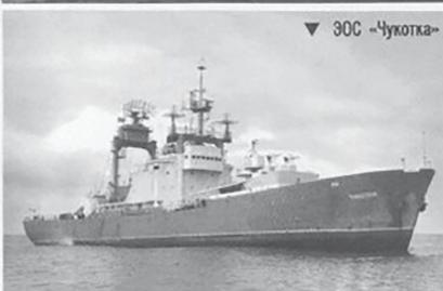
Аппаратура «Трал» и «Алмаз» («Трал-Д») устанавливалась в трюмах кораблей в своих фургонах типа «КУНГ». Станция траекторных измерений была изготовлена в специальном варианте с использованием аппаратуры станции «Бинокль» и антенной системы новой траекторной станции «Кама» разработки ОКБ МЭИ, устанавливаемой на гиростабилизированной платформе в верхней части судна. Этот вариант получил название «Кама-М».
